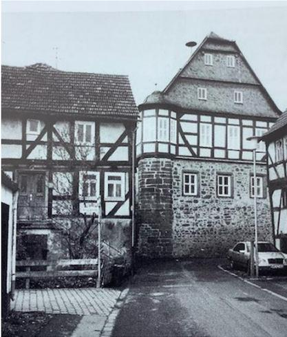
schließt sich an: der Fachwerkteil auf einem massiven Unterbau. Der Giebel ist schieferverkleidet und endet am Satteldach mit dem KrüppelWalmdach...
